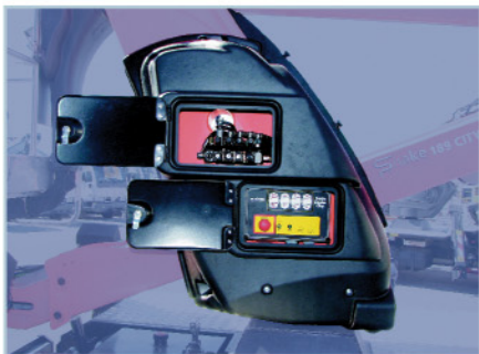
3 Carter e comandi di emergenza in basso Sumpa and low emergency controls Carter et commandes d'urgence en bas Notsteuerungen unten
