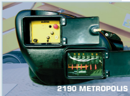
Carter y comandos de emergencia en la parte inferior Noodbediening beneden Nødbetjening fra jordniveau
