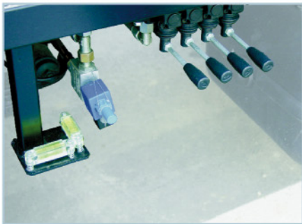
2 Comandi per la stabilizzazione in basso Low stabilisation controls Commandes pour stabilisation en bas Notsteuerungen unten Comandos para la estabilización en la parte inferior Bediening voor de stempelpoten Lavtsiddende støtdebensbetjening)
